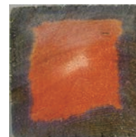
加圧注入処理
